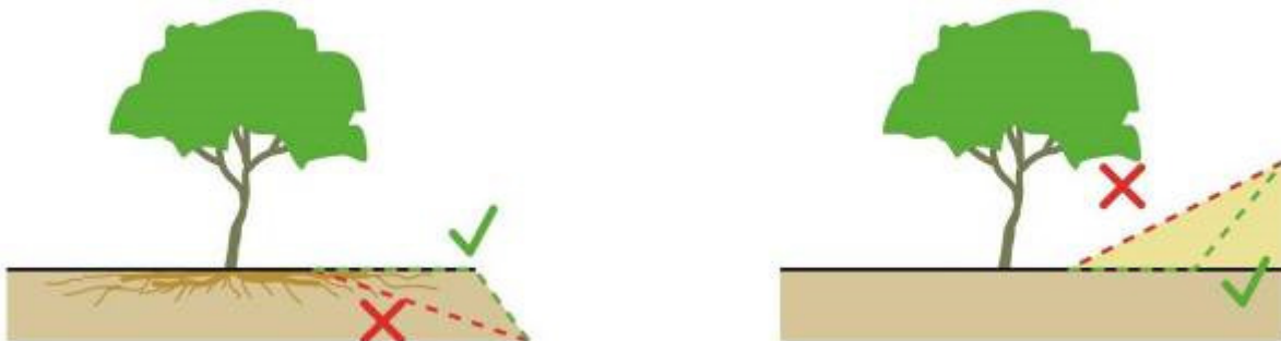
33 pav. pav. Pasirenkant tinkamus techninius sprendinius, formuojant iškasas ir sankasas, galima išsaugoti dalį medžio šaknų
